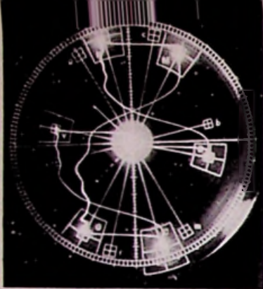
Fig. 39. Oscillogram van het U-V-sig-naal, als het aan de X-Y-in-gangen van de vectorscoop wordt toegevoerd. Aangezien de videofrequente salvo-impuls nog niet werd aangebracht, is deze in het oscillogram niet aanwezig.
